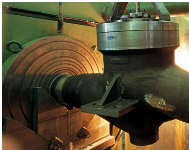
Alle HORA-Ventile werden durch eine Druckprobe auf Sitz- und Gehäusedichtigkeit überprüft.
