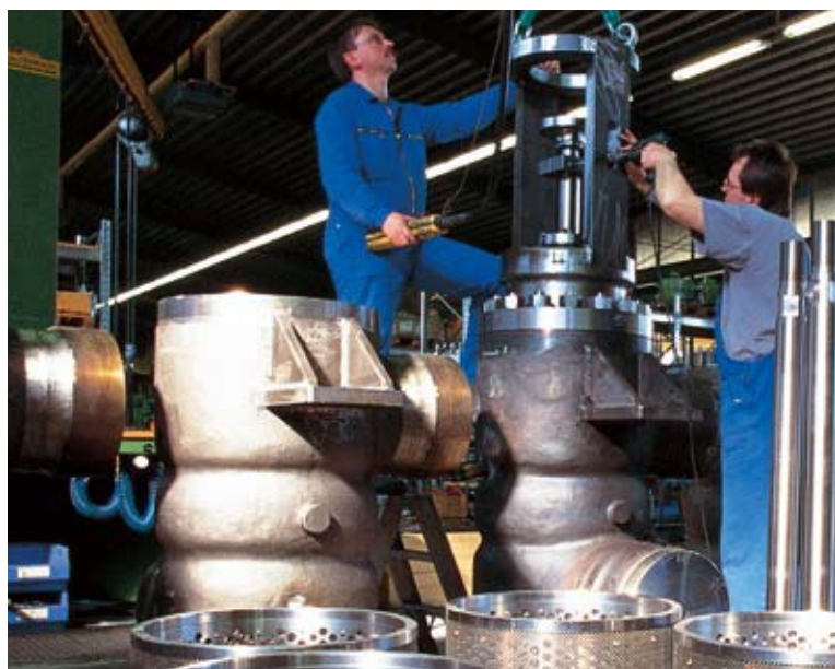
Die Montage und Prüfung der tonnenschweren Industriearmaturen erfordern Millimeterarbeit und Fingerspitzengefühl – wie bei diesen acht Bypass-Stationen für ein Großkraftwerk in Indien. Komplizierte Funktionstests und die mehrtägigen Endabnahmen stellen das Montagepersonal immer wieder vor neue Herausforderungen.
