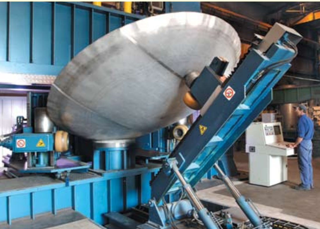
Cold Forming Press 300 Ton
